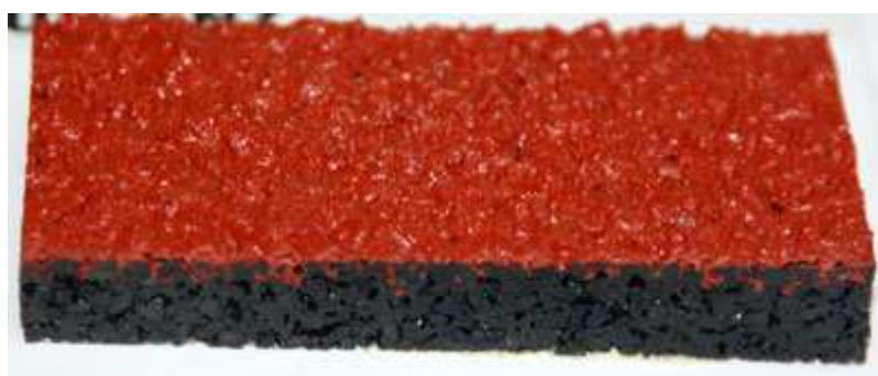
Nawierzchnia poliuretanowa typu „natrysk”
